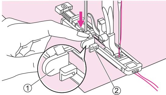
Abbassare la leva asola automatica fino al suo punto più basso e spingerla dietro l'apposito supporto di blocco.
