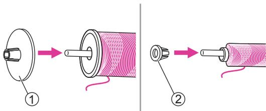
3. Posizionare il rocchetto di filo ed il ferma spola all'interno del porta spola orizzontale. Scegliere il ferma spola (grande/piccolo) in base al diametro del rocchetto di filo spingendolo contro il rocchetto fino a farlo aderire ad esso.
