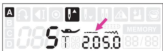
La lunghezza punto può essere regolata premendo il relativo tasto " + " per allungare oppure " - " per accorciare. Il punto zigzag standard è impostato su "2.5" o inferiore.
